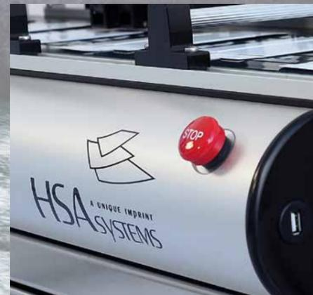
Not-Halt rechts vorne an der Maschine.
