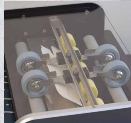
Integriertes Auswurfsteuersystem mit Auswurfsensor.
