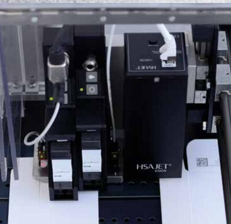
Камера и печатающая головка на общей станине, регулируемой по высоте и ширине конвейера.
