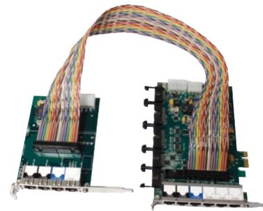
Die CB6e-Steckkarte ist PCI express basierend und steuert bis zu acht Druckköpfe (101,6 mm / 4" Druckhöhe). Mit einer optionalen Anschlussweiterung können weitere acht Druckköpfe (203,2 mm / 8" Gesamtdruckhöhe) mit der gleichen CB6e-Karte gesteuert werden.
