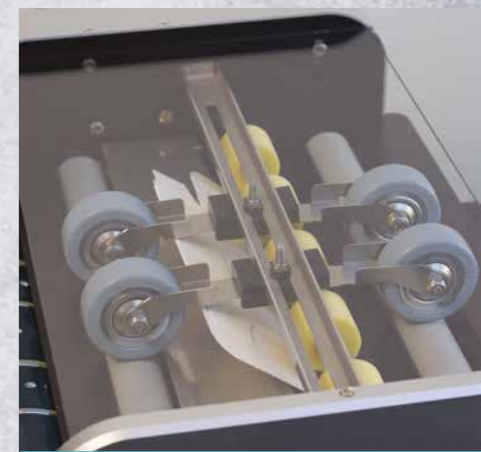
Sistema de control de expulsión integrado con sensor de verificación de expulsión.
