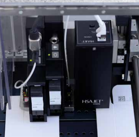
Cámara y cabezal de impresión integrados en un mismo soporte, con altura ajustable y a través del transportador.
