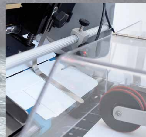
La rueda de guiado mantiene el producto en su sitio en el transportador.
