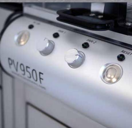
Кнопки PC On, Emergency Stop, Reset и Fan находятся на передней части панели машины.
