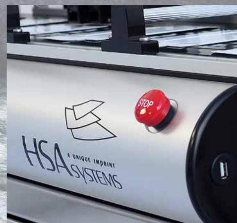
Кнопка экстренной остановки находится справа на передней панели машины.
