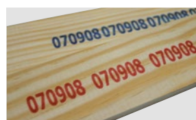
Impressions bleues et rouges sur le bois avec les encres B2025si et R2021si
