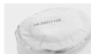
Impression bleue résistante sur feuilles d'aluminium avec l'encre B2025si
