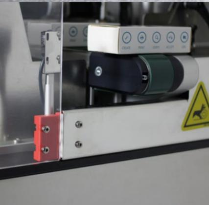
Wird die Abdeckung während des Betriebs geöffnet, stoppt der Sicherheitsschalter die Maschine sofort.
