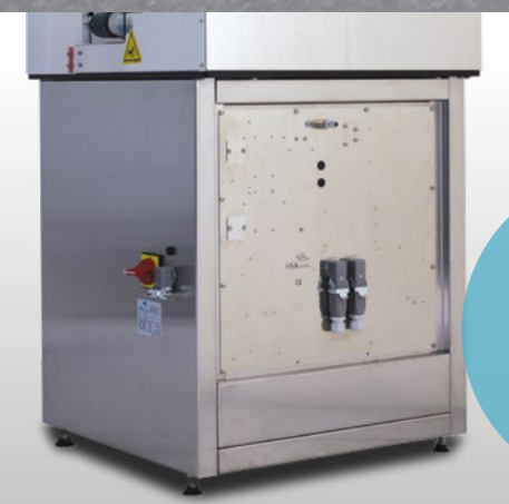
Панель разъемов встроена в шкаф. Она включает все внутренние входы и внешние выходы.
