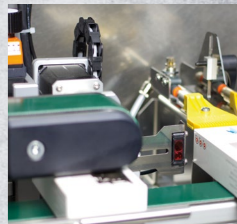
Интегрированная система управления отбраковкой с датчиком.
