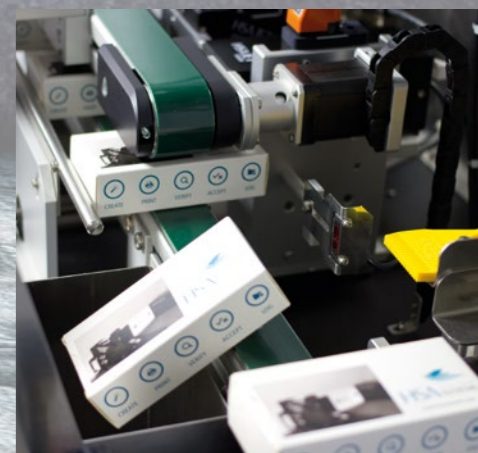
Отбраковка посредством струи воздуха. Отбракованные коробки попадают в корзину.
