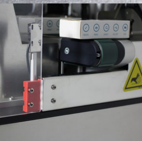
Аварийный выключатель остановит работу устройства, если в процессе производства будет открыта крышка.
